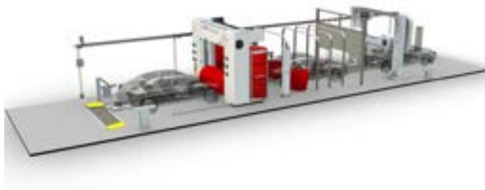
Figuur 2: Het concept ADAS-Teststraat gebaseerd op een automatische wasstraat waarbij de auto op een lopende band staat en stopt bij verschillende stations (bubbles-carwash, 2021).
